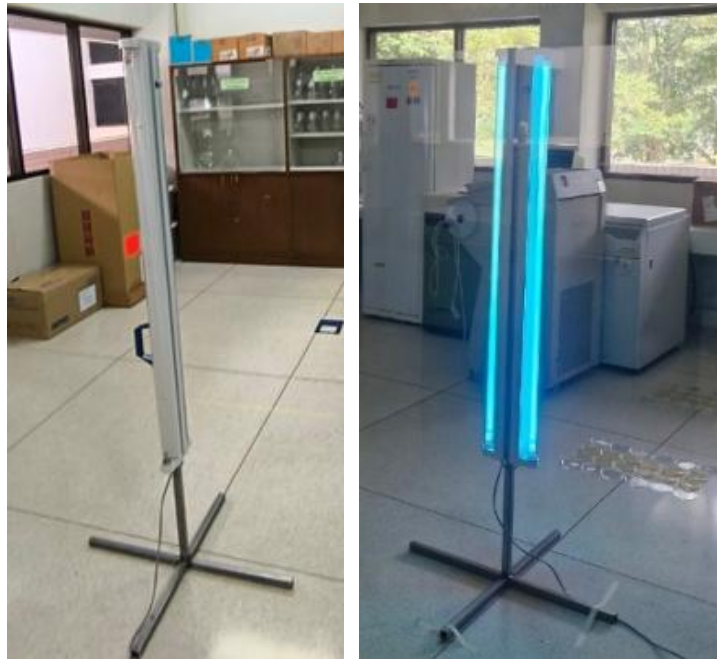
ภาพแสดง เครื่องฆ่าเชื้อด้วยรังสียูวี-ซี แบบเคลื่อนที่
