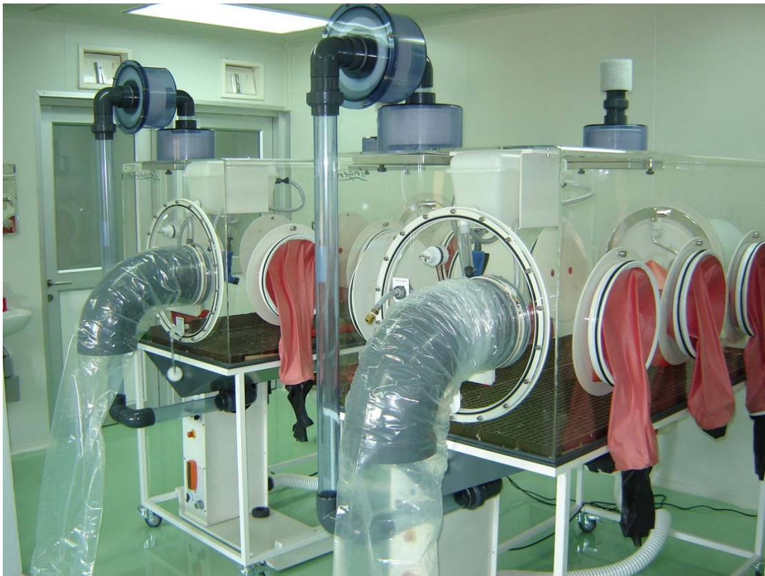
รูปที่ 18 แสดง poultry isolator ซึ่งมีแผ่นกรอง HEPA filter (แบบกลม) อยู่ด้านบนของตู้สำหรับกรองอากาศทั้งก่อนเข้าตู้และก่อนปล่อยออกภายนอกอาคารเลี้ยงสัตว์ทดลอง
