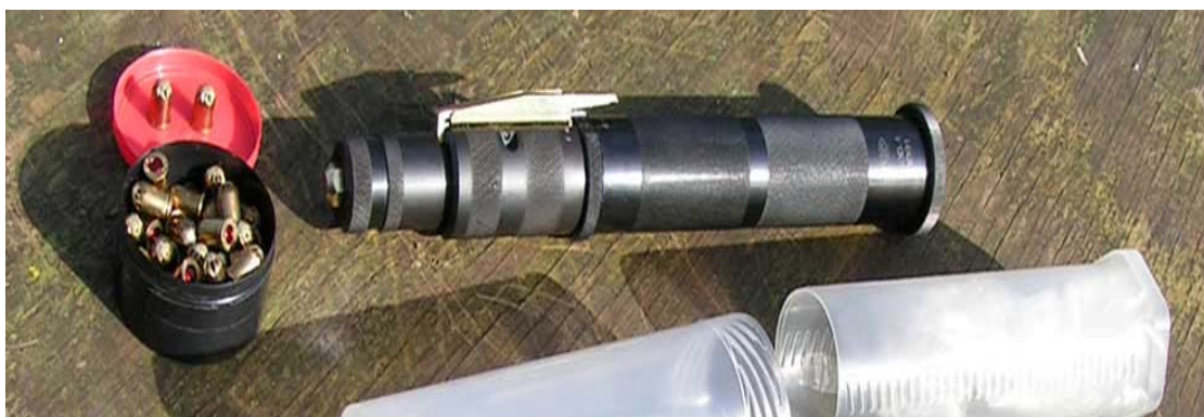
รูปที่ 13 แสดงตัวอย่างของ captive bolt pistol ที่ใช้สำหรับทำให้สัตว์หมดสติ
