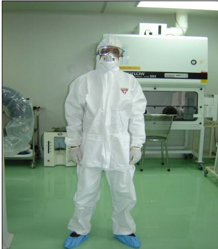
รูปที่ 19 แสดงการสวมใส่อุปกรณ์ป้องกันร่างกายส่วนบุคคลในการปฏิบัติงานในอาคารคอกสัตว์ทดลองที่มีการปฏิบัติงานกับเชื้อโรคของศูนย์ทดสอบและวิจัยคุณภาพชีววัตถุสำหรับสัตว์ กรมปศุสัตว์
